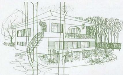
C'EST un pavillon de banlieue, comprenant cinq pièces, est chauffé par une chaudière à tirage naturel, installée dans la cave. Ici, on a adopté le Variostat pour maintenir l'équilibre entre la température de l'eau de chauffage et la température extérieure. Un moteur oléo-électrique cuivre et ferme les volets de tirage et de contre-tirage par action progressive.
